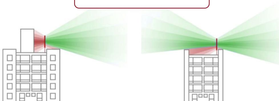
**Неправильно!** Антенна установлена не на самой высокой части здания. Значительная часть диаграммы закрыта конструкциями здания.
