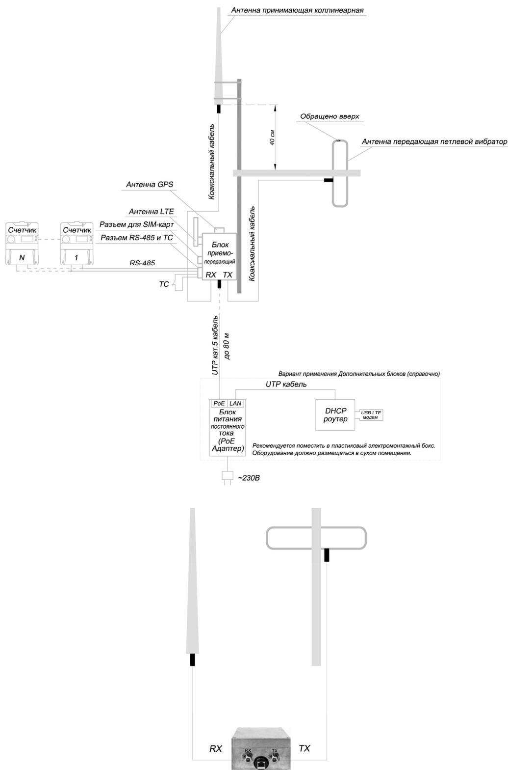
Рисунок А3 – Способ подключения Базовой станции
