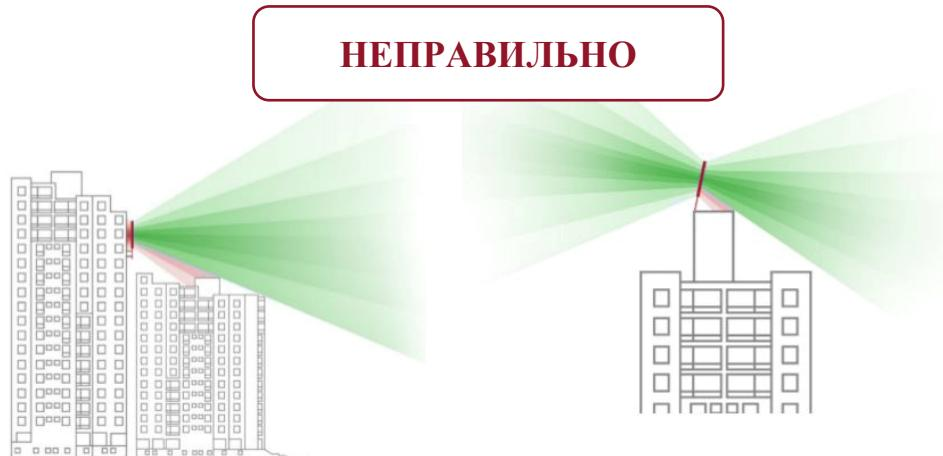
**Неправильно!** Антенна установлена не на крыше здания, а сбоку.
