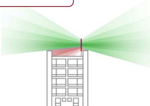
**Неправильно!** Антenna установлена не на самой высокой части здания. Значительная часть диаграммы закрыта конструкциями здания.
