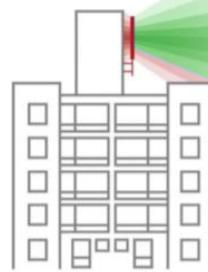
**Неправильно!** Вокруг антенны присутствуют другие элементы здания, препятствующие распространению сигнала. Полный горизонт не виден.
