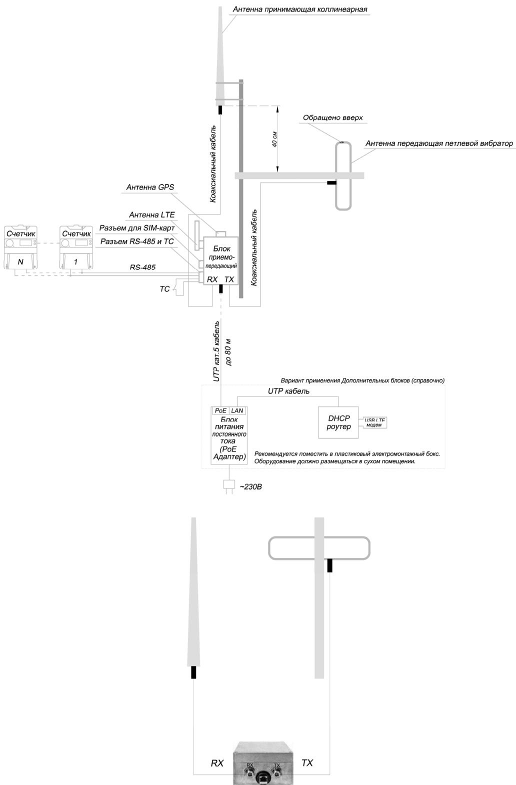
Рисунок А3 – Способ подключения Базовой станции
