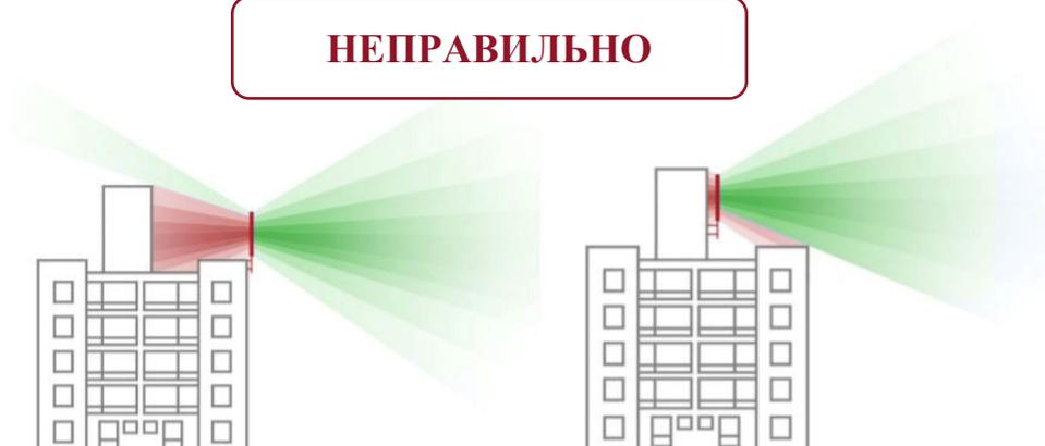
**Неправильно!** Вокруг антенны присутствуют другие элементы здания, препятствующие распространению сигнала. Полный горизонт не виден.
