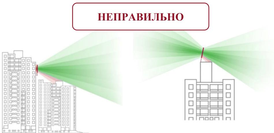
**Неправильно!** Антенна установлена не на крыше здания, а сбоку.
