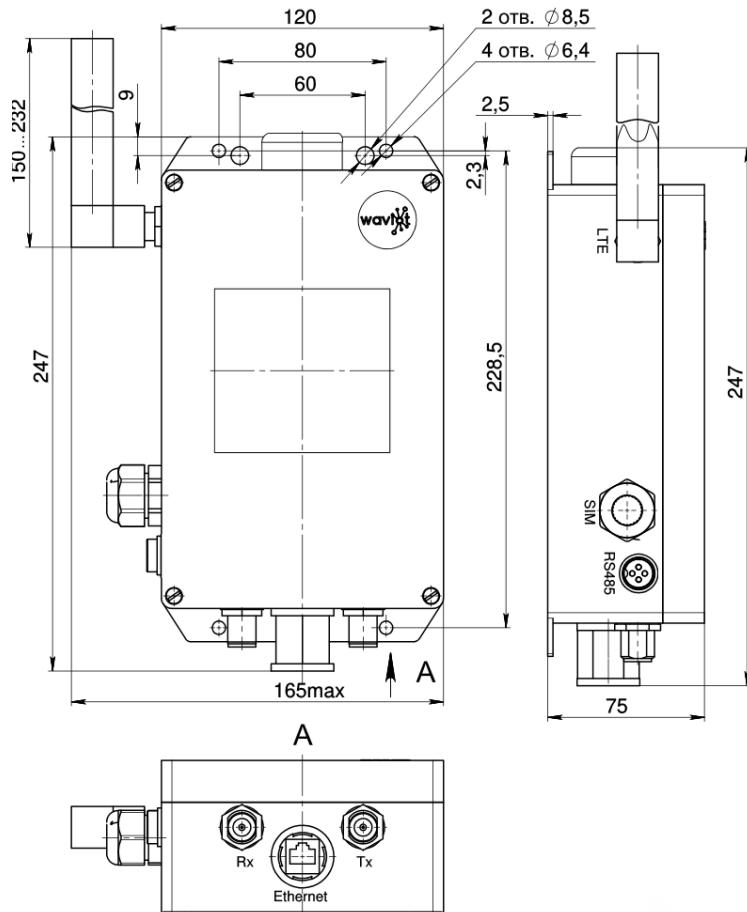
Рисунок А1 – Габаритные и установочные размеры блока приемо-передающего Базовой станции (GSM антenna показана условно)
