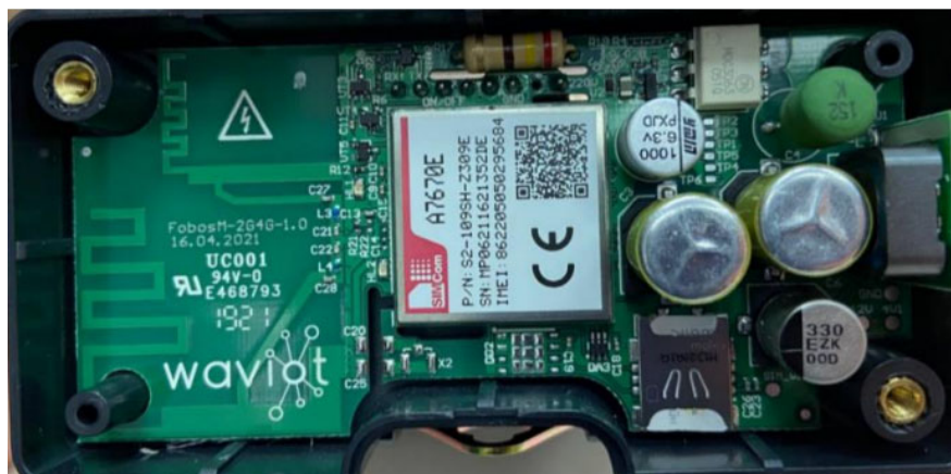
Рисунок 6.3 – Плата сменного модуля связи 2G/4G
