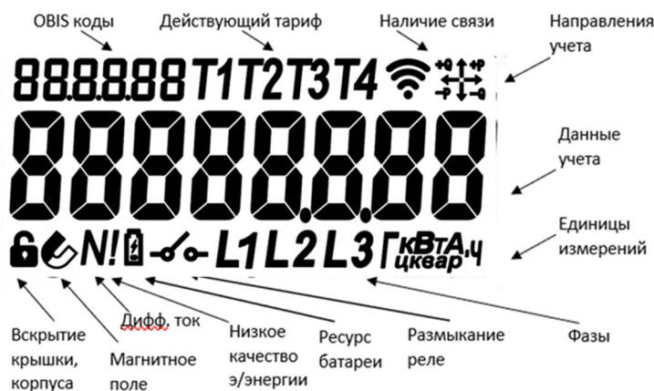
Рисунок 3.3 – Карта сегментов дисплея и их назначение
