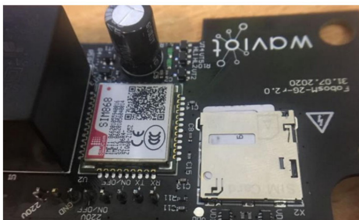
Рисунок 6.2 – Плата сменного модуля связи 2G.
