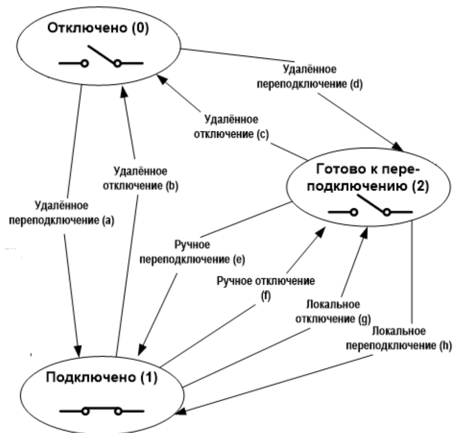
Рисунок 5.1 – Схема переходов состояний реле нагрузки.
