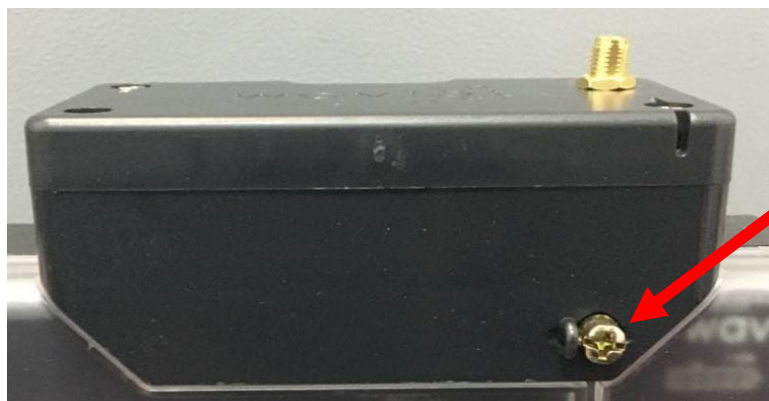
Рисунок 6.4 – винт крепления корпуса модуля связи
